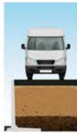
DLF10GSZ gelijkmatig verdeelde overlast 25 kN/m 2
